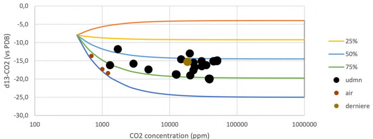
Figure 13 : Variations isotopiques du carbone ( $\delta^{13}\text{C}\text{-CO}_2$ ) du CO<sub>2</sub> dans l'air et dans les gaz du sol à la station UDMN. La composition du pôle magmatique est fixée à -4.0 per mil (signature des bullages du site C1 – estran de l'aéroport).
