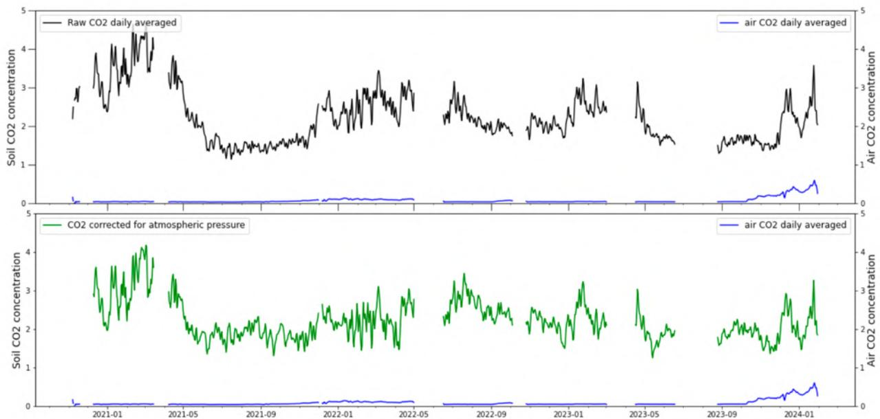
Figure 12 : Concentration en CO<sub>2</sub> dans le sol à la station permanente UDMN. Comparaison entre les données brutes (noir) et les données corrigées de l'influence de la pression atmosphérique (vert). Bleu : concentration dans l'air (1 m au-dessus du sol). Les variations de concentrations dans l'air sont liées à l'activité biogénique (©OVPF-IPGP / REVOSIMA).
