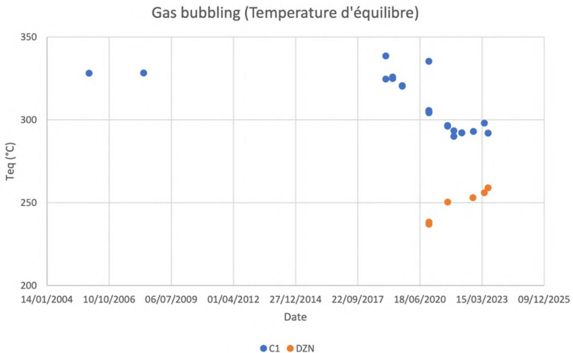
Figure 15 : Température d'équilibre des fluides au sein du système hydrothermal. La température d'équilibre entre le CO<sub>2</sub> et le CH<sub>4</sub> dans le système hydrothermal est estimée à l'aide de l'équation de Giggenbach 1992.
